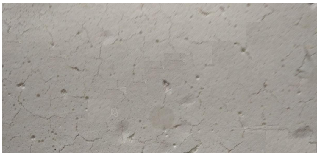
Рис. 2. Вид поверхности образца пенопласта с целлюлозной фиброй в качестве армирующей добавки
