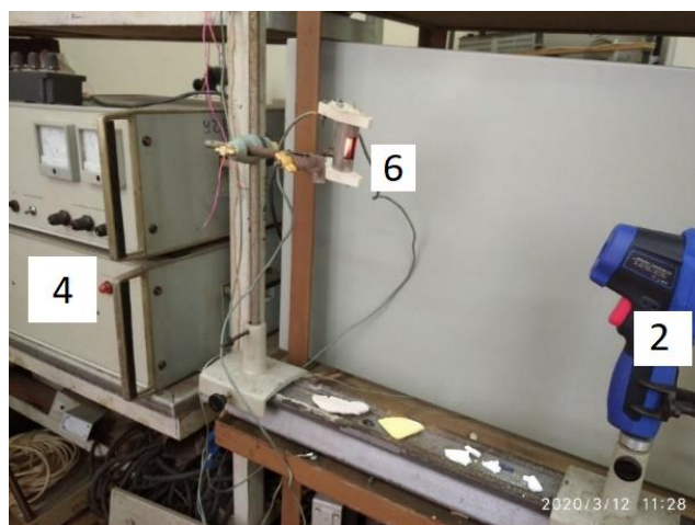
Рис. 2. Установка. ИК - термометр 2 расположен напротив глобара 6, запитанного от источника стабильного тока 4
