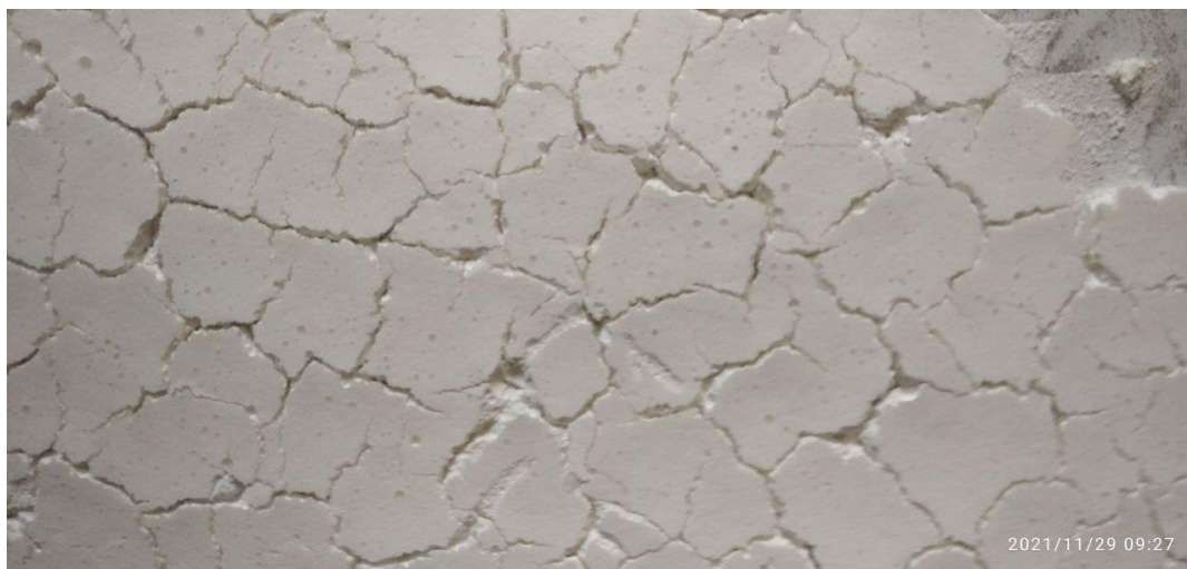
Рис. 1. Вид поверхности образца пенопласта без армирующих добавок
