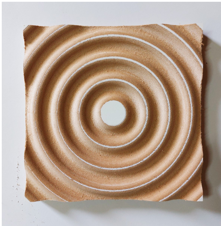
Рис.17. Завдання №1. Дизайн рельєфних і фактурних поверхонь. Матриця з МДФ для подальшого лиття з гіпсу
