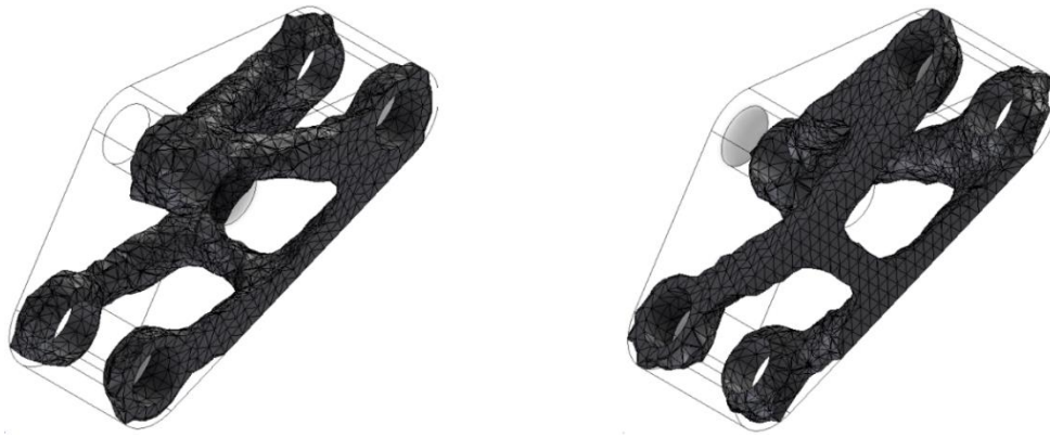
Рисунок 5 – Пропонована конструкція №4: 17,6 кг. Зниження ваги: 81%
