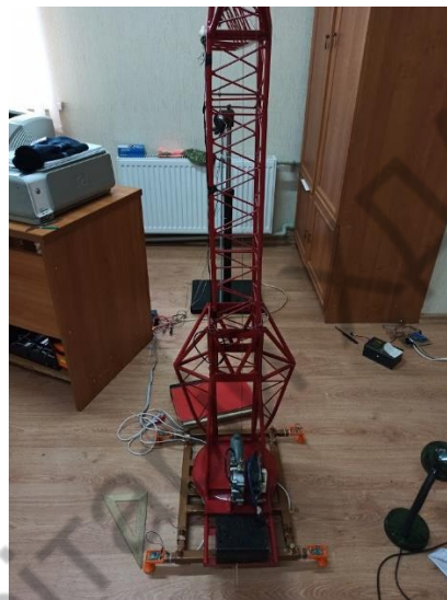
Рисунок 2 – Експериментальна установка – модель крану
