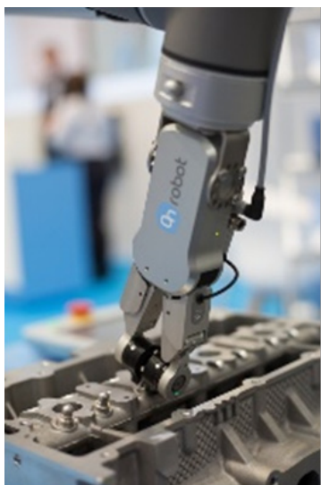
Рис.1. Маніпулятор-захоплювач «RG2-FT». OnRobot. Данія. Фото https://ifr.org/ifr-press-releases/news/robots-get-hands-and-eyes-like-humans
