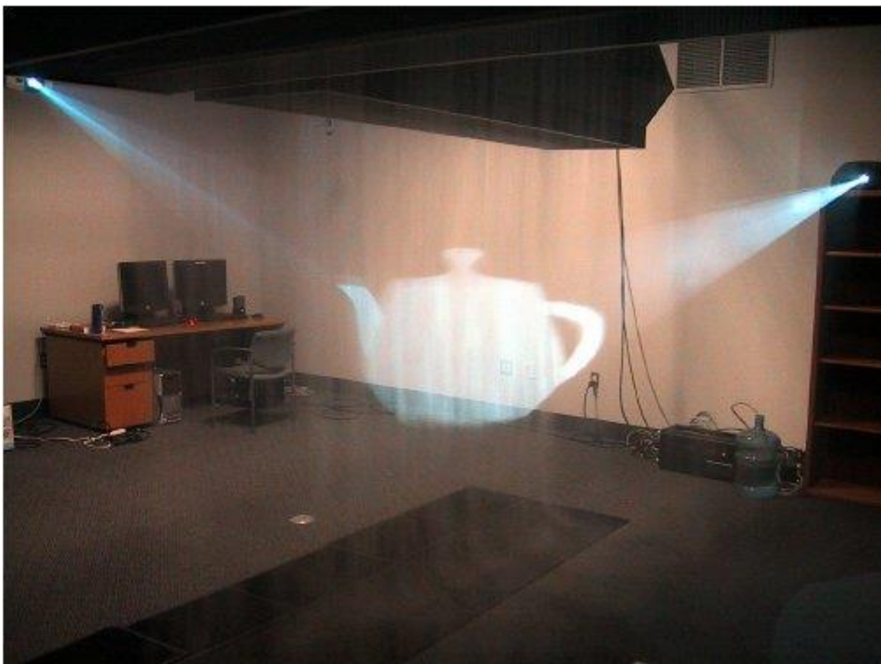
Іл. Б.2.1.7. Прототип нематеріального дисплея, що показує тривимірний чайник. Ча Лі та соавтори. 2009 р. [249, с. 193].
