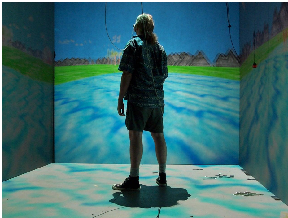
Іл. Б.2.1.9. Автоматичне віртуальне середовище «Cave» в EVL. 1993 р. Університет Іллінойсу в Чикаго. Користувач всередині CAVE. Фото зроблено під час модернізації CAVE для використання нових DLP-проекторів «Christie Mirage» на 5000 люменів. © Daverape. URL: https://en.wikipedia.org/wiki/Cave_automatic_virtual_environment
