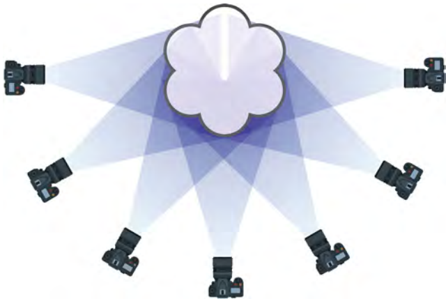
Іл. 2. Розташування камери під час фотограмметричної зйомки
